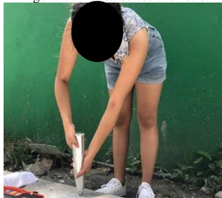
Figura 7: Prueba de esclerómetro.
