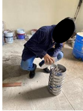
Ilustración 5: Ejecución de la prueba de granulometría.
