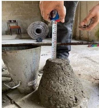
Ilustración 9 Prueba de Revenimiento del concreto
