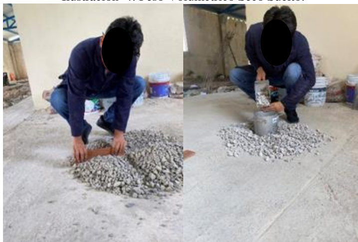
Ilustración 4: Peso Volumetrico Seco Suelto.
