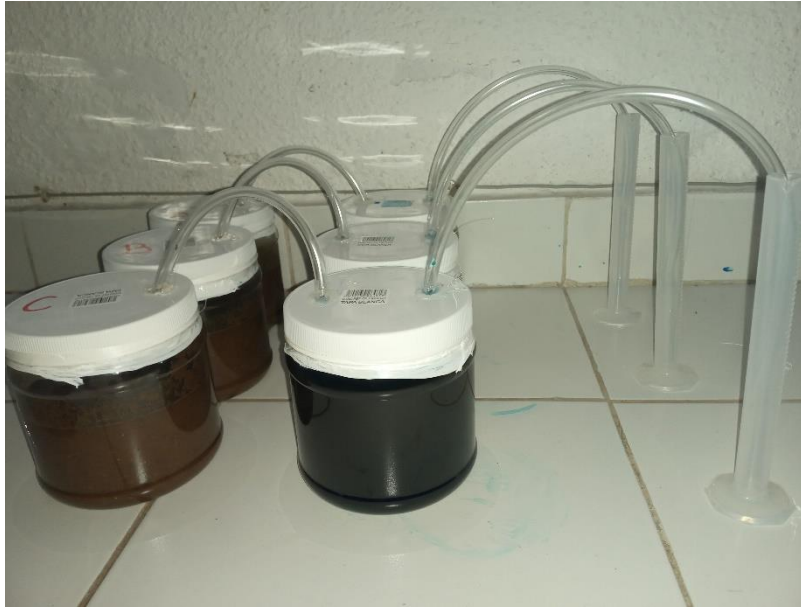
Figura 2 Montaje experimental para la determinación de biogás a escala de laboratorio en reactores tipo batch.
