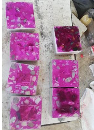
Figura 8: Resultados de carbonatación a los 28 días
